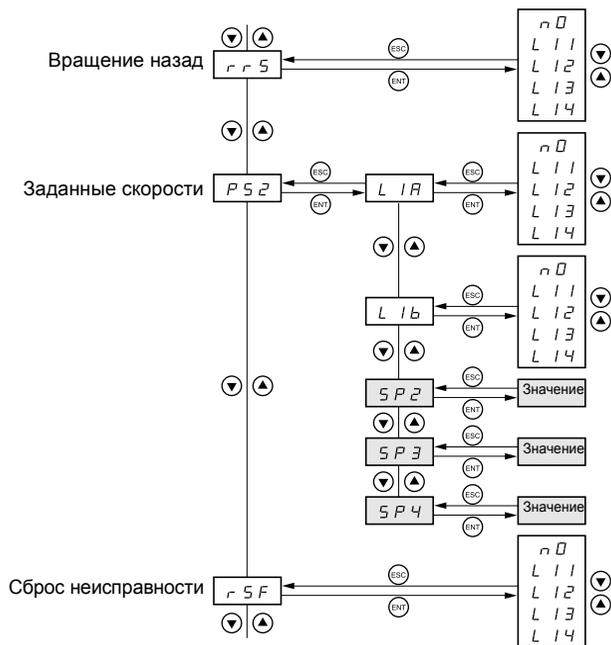
Не заштрихованные параметры можно изменять только при остановленном двигателе и заблокированном ПЧ
